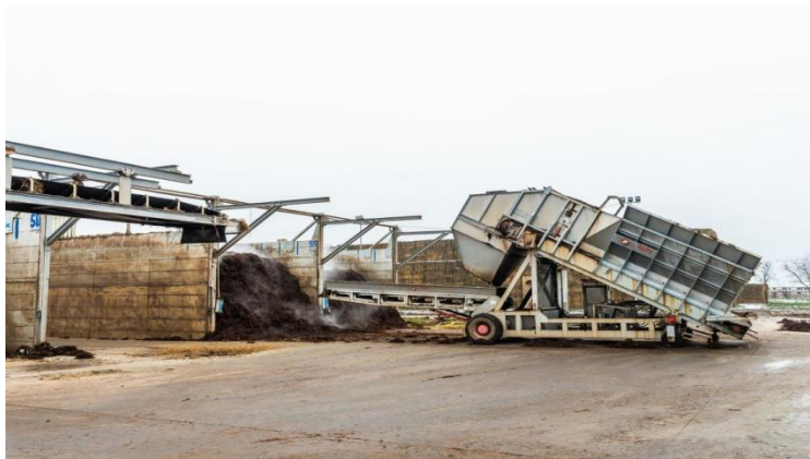
Слика 6.: Изглед специјализоване машине „Бункерфилер“ у процесу ротације компоста
