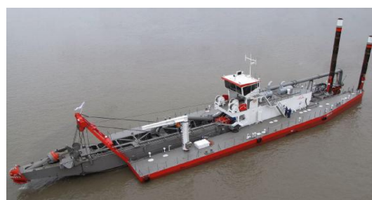
Слика бр. 11: ИНС Рефулерни багер за шљунак, Нкmax= 40-45 т
