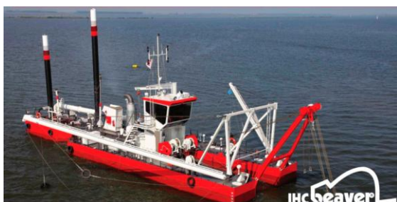
Слика бр. 10: ИНС Рефулерни багер за песак, Нкmax= 14 т
