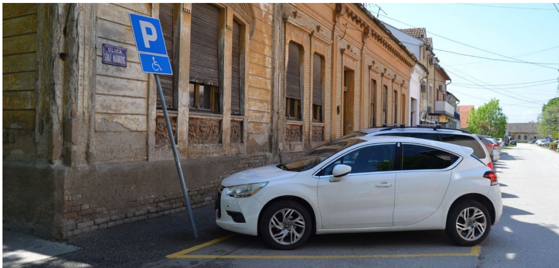
Слика 3.1.13. Центар Ковина Улица Соње Маринковић, димензија паркинг-места су недовољне за безбедно паркирање
